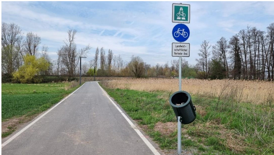
Abbildung 51: Angewinkelter Abfallbehälter entlang des Radschnellwegs Darmstadt-Langen (Quelle: IGS)
