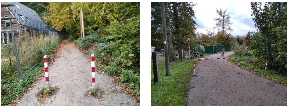
Abbildung 4: Poller und Umlaufsperrn stellen anordnungspflichtige Verkehrseinrichtungen dar, wenn sie rot-weiß gestreift sind (Quelle: eigene Aufnahme)
